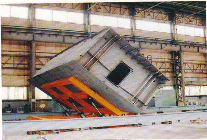
▲ 40 TON TURNING CART * 용도 : BOX 내, 외면 용접시 회전용
