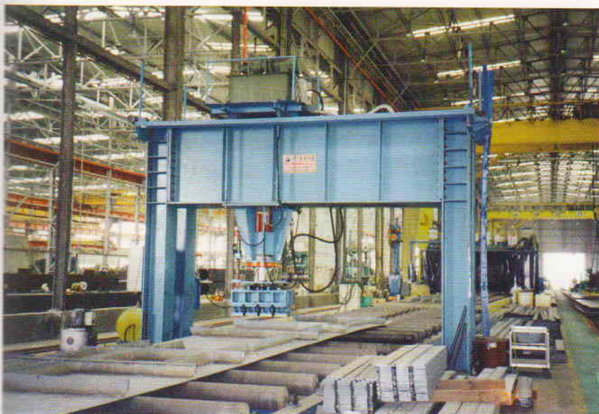
◀ PRESS Type 종+횡 RIB 동시 교정가능
