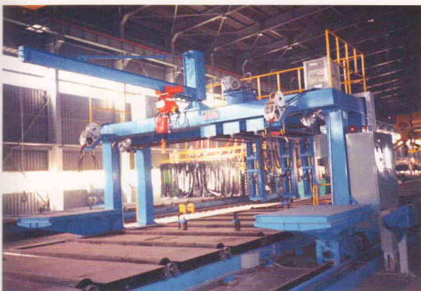
◀ HOIST : 500kg × 1Set CO2 WELDER : 500A × 1Set
