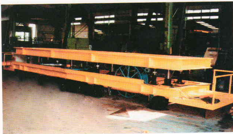
▲ 60 TON LIFTING CART * 용도 : BOX 도장장 이송용
